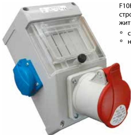
Она подходит для подключения 3-фазных и однофазных электрических приборов с переключателем для выключения. В версии на 32 А поставляются со стеклянным предохранителем F10H/250 (2x) для однофазной розетки. Свое применение найдут в экстерьере и интерьере, на стройках, в жилых домах и зданиях, в промышленном распределении. Распределитель содержит втулку для уплотнения кабеля. Она содержит розетки IERN и VZ16.
